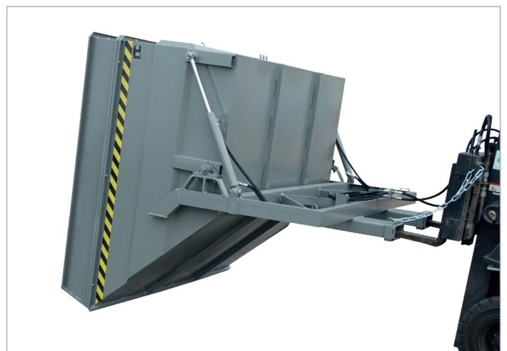
BKC-H (mit hydraulischer Kippvorrichtung)
